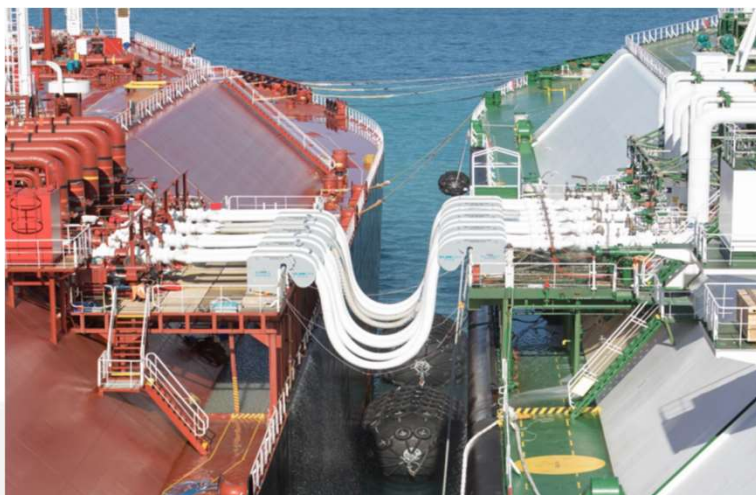
Transferência de GNL via mangotes criogênicos (em todos os casos)
